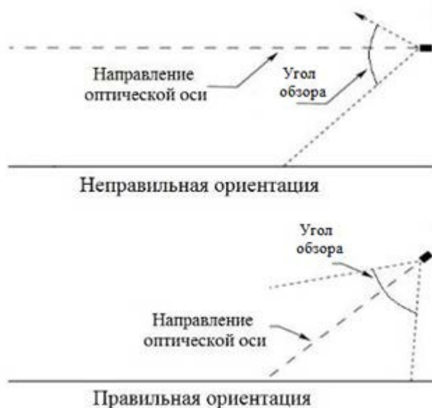
Рисунок 4 – Установка извещателя по отношению к горизонту
