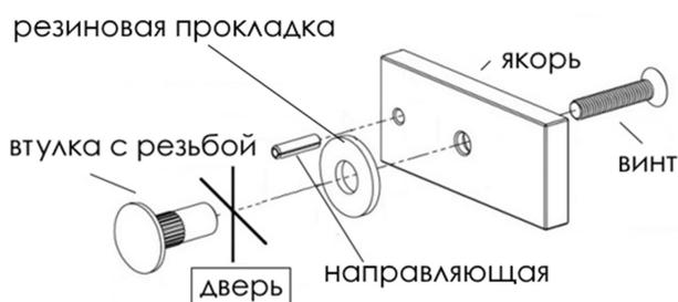
Выбрать необходимый вариант крепления. Установить замок и якорь, согласно выбранного варианта. Обратите внимание, якорь за счет резинового кольца должен иметь люфт около 3-5 мм относительно основания, для обеспечения плотного прилегания к замку. Произвести подключение замка, согласно схеме.
